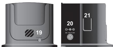
19. **Indicador frontal de carga** — Se enciende durante la carga de la pila y se apaga cuando la pila está totalmente cargada. Si se coloca una pila, ya cargada, en el cargador el LED no se encenderá y la acción de carga no funcionará. Aunque usted puede monitorizar las llamadas entrantes mientras que la radio está dentro del cargador, no intente transmitir mientras que esté en el cargador.
